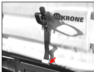
Gancio cinghia di tensionamento (allargamento gancio)
