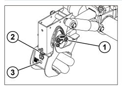
Fig. 5-97: Fastening the Twinlift
