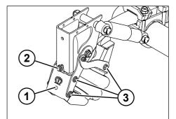
Fig. 5-98: Fastening the Twinlift
