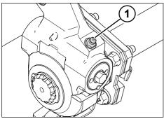
Fig. 5-37: ASA grease nipple
